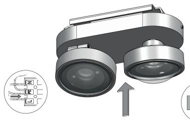
6) Drücken Sie die Leuchte in Richtung Verschraubung und ziehen Sie die Madenschraube fest an. Installation beendet.
