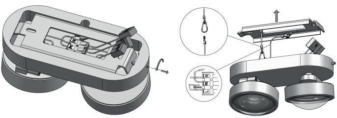
1) Lösen Sie die seitliche Madenschraube.
