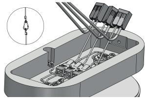
4) Verbinden Sie die Fangseile. Schließen Sie die Leuchte an die Netzleitung an (L, N und PE).
